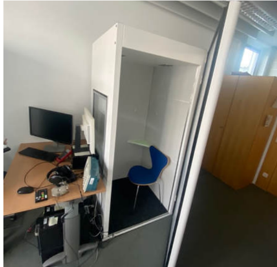
Abb. 6: Technik und Hörkammer in der der Proband mit den Kopfhörern sitzt (Quelle: Christoph Hofstetter)
