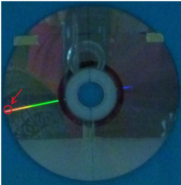
Abb. 8: Weißes Licht trifft mit großem Einfallswinkel auf eine CD: Hierbei entsteht ein farbiger Lichtstreifen. (Pfeil: ein zu messender roter Lichtpunkt ist hier rot markiert) (eigene Aufnahme)
