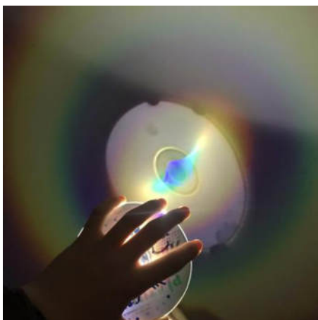
Abb. 4: Ringförmiges Lichtspektrum auf einem Schirm
