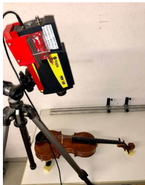
Abb. 5: Versuchsaufbau: Laserstrahl des LDV wird auf die zu messende Saite gerichtet; eigenes Bild
